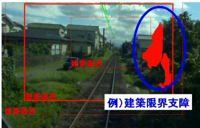
図3 画像解析より建築限界支障箇所を判定した例
