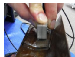
図9 エコーゲルパッドを用いた探傷
