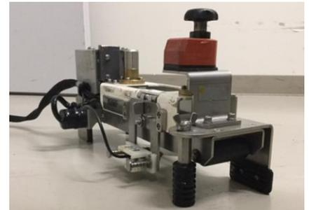
図1 頭部横裂測定器
