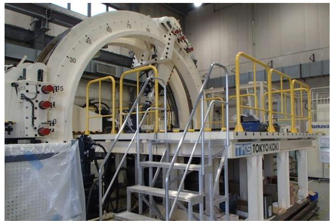
図 1. レール締結装置疲労試験装置
