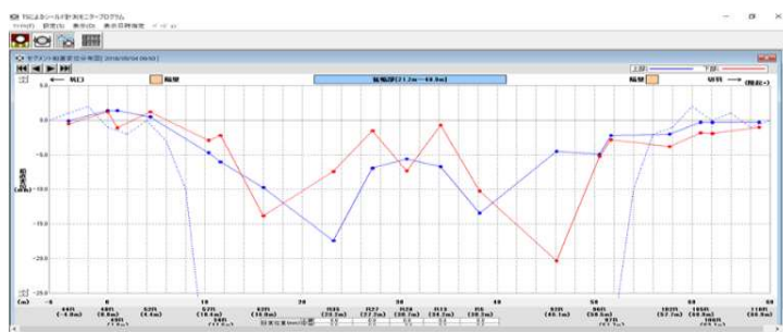
図3 変位計測モニター（青：上部変位，赤：下部変位）
