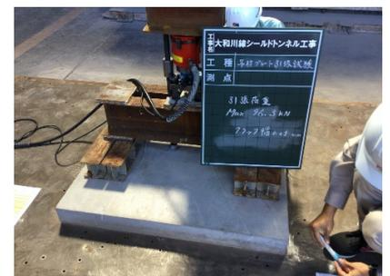
写真-3 引き抜き試験
