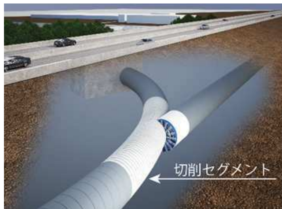
図-1 直接切削接続状況
