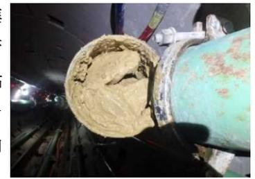
図-4 排泥管内閉塞状況
