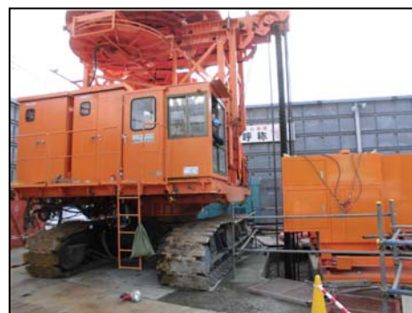
図2 水平多軸式掘削機（EMX-150）
