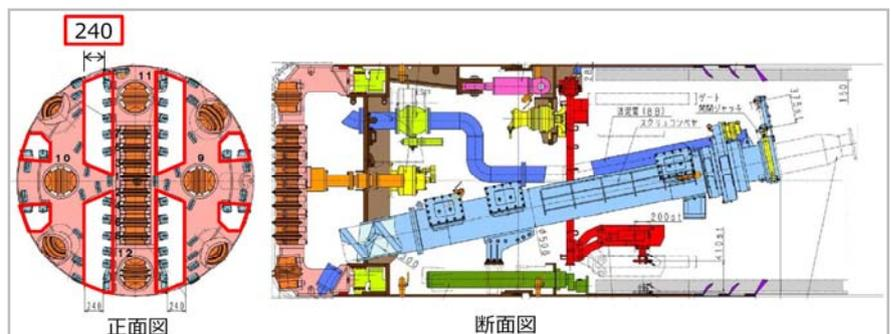
図-3 泥水泥土圧併用型シールドマシン
