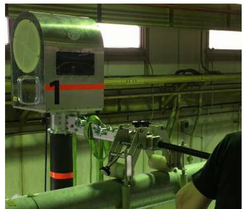
図 3 移設用治具による高欄上移動実験
