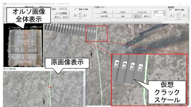
図 3 損傷抽出・計測ソフト
