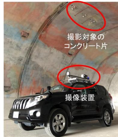
図1 モーショントラッキング補償の原理 図2 実験用トンネルにてモーショントラッキング補償装置及びサーモカメラを搭載した車両
