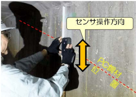
写真2 磁気センサを用いた動的測定
