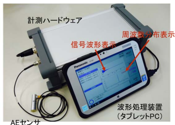
図 1 現場検査装置の構成及び外観
