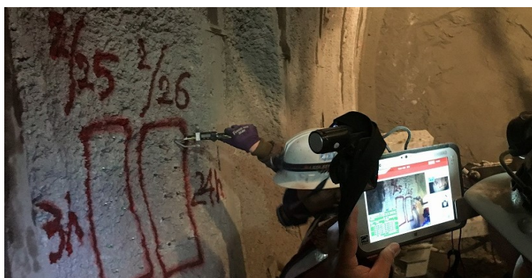
図-5 遠隔立会状況（吹付けコンクリート初期強度試験）
