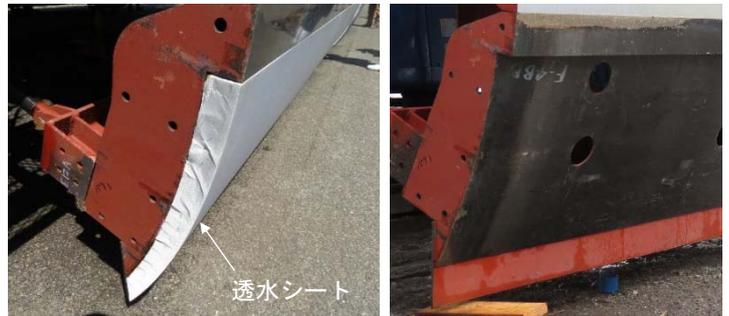
写真-1 透水シートの設置状況
