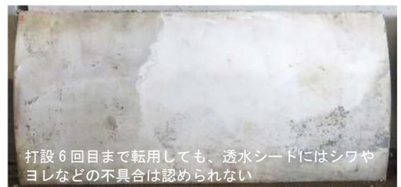
写真-4 透水シートの設置状況
