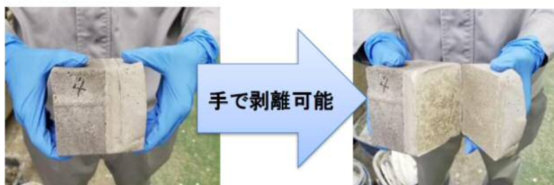
写真-1 剥離性の評価実施例（手力で剥離）
