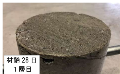
写真－7 剥離剤ありの破断面 (R-28)
