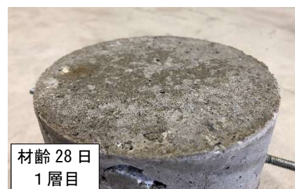
写真－6 剥離剤なしの破断面 (N-28)
