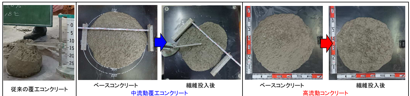
写真-1 各種コンクリートのスランプ（フロー）試験状況
