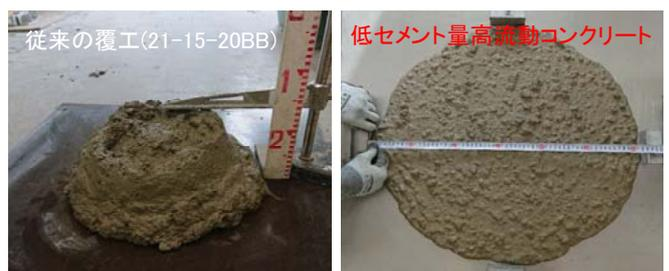
写真-1 スランプ(フロー)試験後の外観
