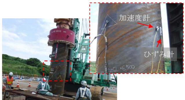
写真-4 衝撃載荷試験
