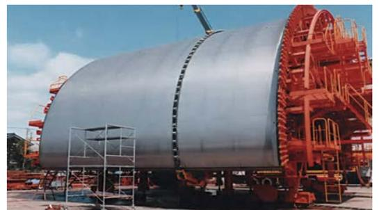
写真-2 自動ケレン装置・剥離剤噴霧装置
