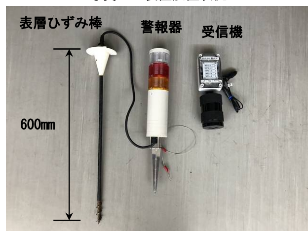
写真-2 簡易ひずみ計測システム
