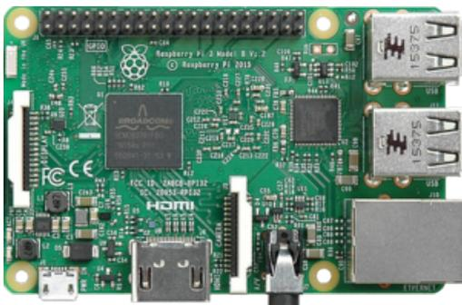
図 2 Raspberry Pi 3 Model B の概観
