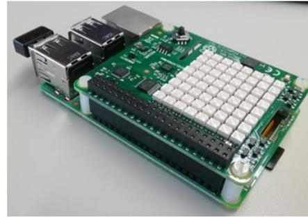
図 4 Raspberry Pi 3 に Sense Hat を組み込んだ状態
