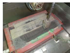
写真-3 タンパ転圧
