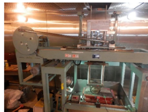
写真-1 低温水浸式ホイールトラッキング試験機
