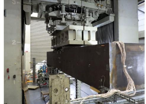
図 4 単体曲げ試験状況
