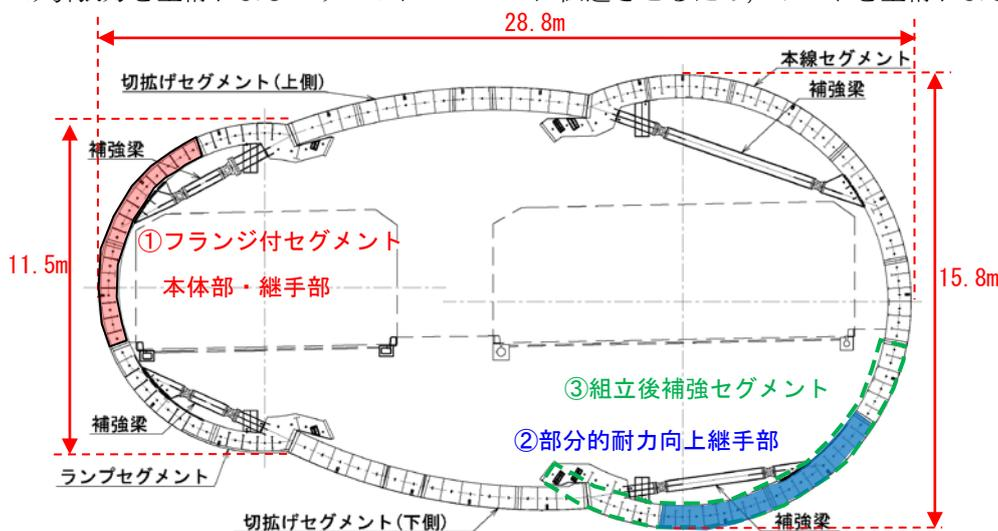
図1 対象分岐合流部構造図および試験項目
