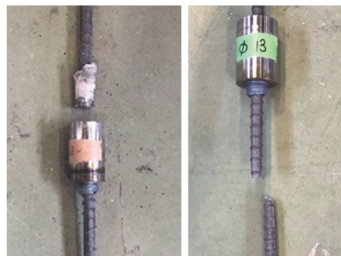
写真-2 引き抜き破壊
