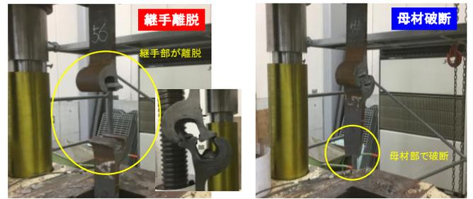
写真-1 継手引張破壊性状
