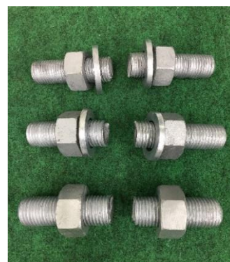
写真 4 せん断試験後
