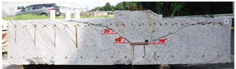
写真-2 試験体の切断面のひび割れ状況
