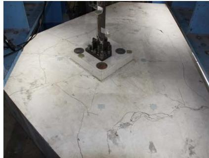
写真-1 床板上面のひび割れ状況
