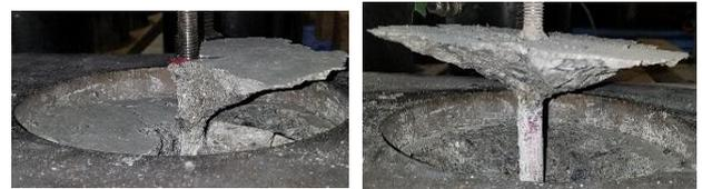
図-5 接着系コーン破壊 補修無し(左)補修有り(右)
