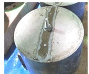
し、ひび割れ幅を0.1mm、0.3mm（管理値+0.1mm以内）に調整しコンクリートビス（φ4.0mm、全長45mm）をひび割れ部分に挿入して幅を保持した。注入補修有りの試験体は、図-2に示すように、ひび割れ導入後、所定の混合比にて主剤と硬化剤を混合し、注入材が流出しないようにシール材にて囲いを施しその中に溜め注入した。養生は2週間とし、その後、非拘束でのアンカー引抜き試験を実施した。
