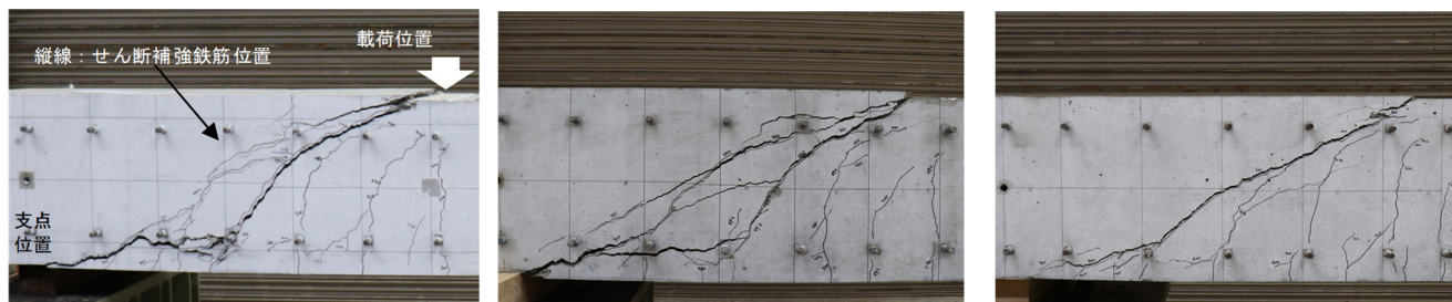
写真-2 最終破壊状況（せん断破壊区間）
