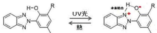
図-4 ベンゾトリアゾールの構造変化
