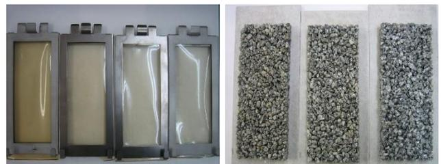
写真-1 紫外線吸収剤 B を使用した際の供試体
