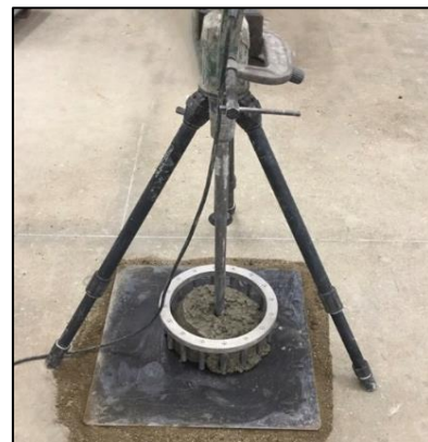
写真-1 加振 J リングフロー試験の状況
