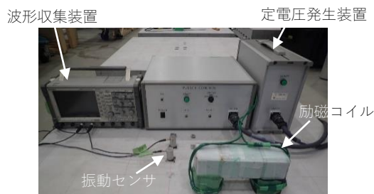
図-3 計測装置外観
