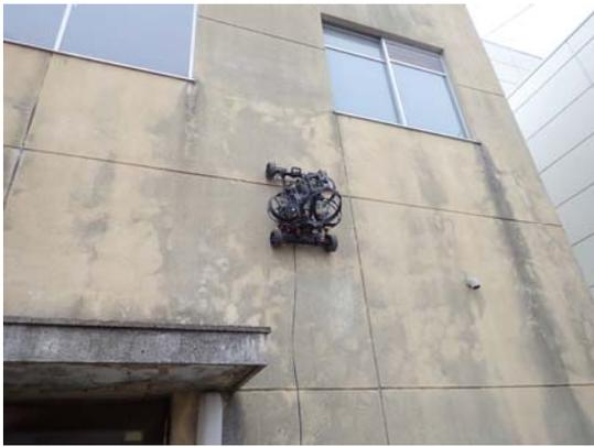
写真3 壁面走行ロボットによる外壁調査状況
