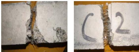
図-4 #2(左)と X2(右)のひび割れ面
