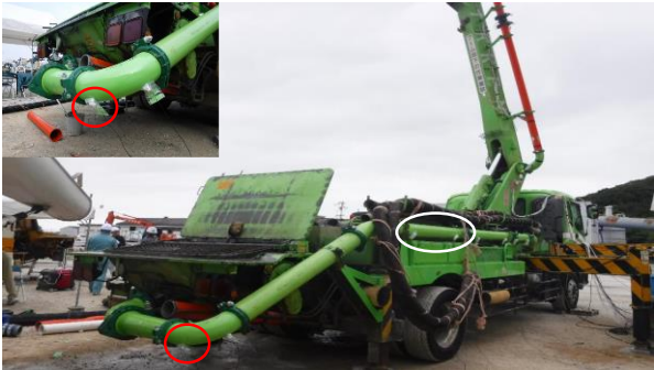
写真-2 加速度センサー取り付け箇所
