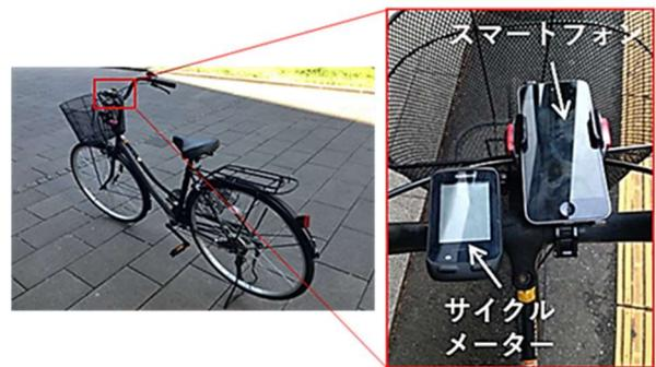
図1 構築した計測システム
