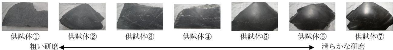
写真-3 岩石を切り出した供試体
