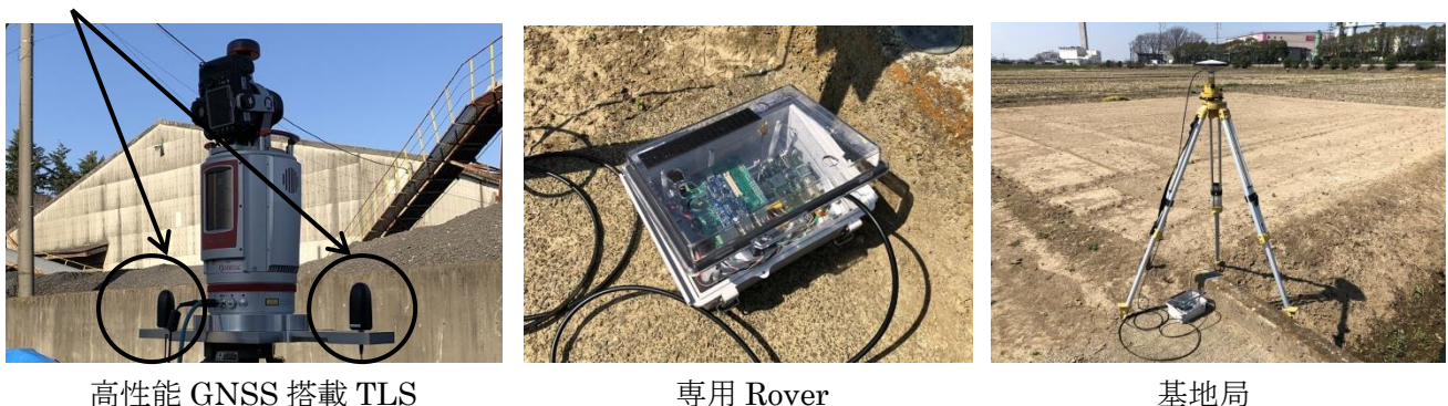
図-2 高性能 GNSS を搭載した TLS
