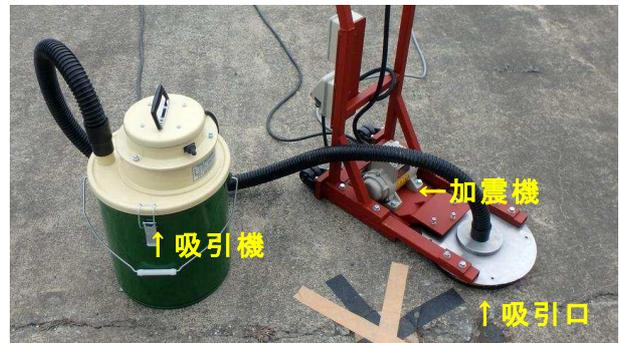
写真-3 つまり物除去装置の構成
