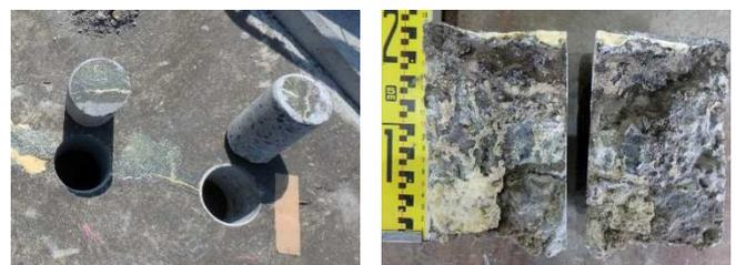
写真-5 ひび割れの接着状況
