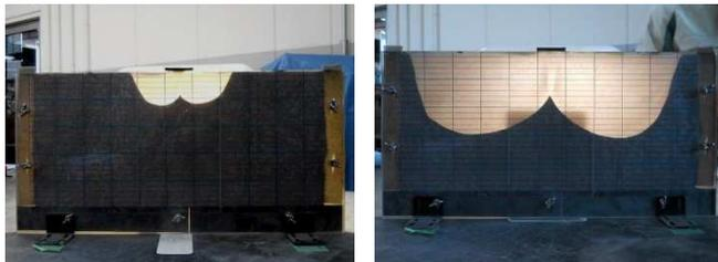
写真-1 実験状況 (シール長左:0mm 右:100mm)
