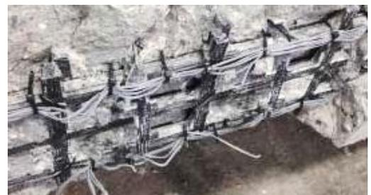
写真 2 終局時破壊面(せん断試験)
