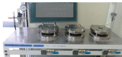
図 8. 透水試験状況
