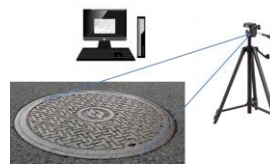
図 1-2 「写真（画像判定）による摩耗量計測の一例」
