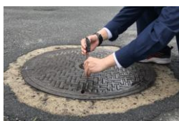
図 1-1 「目視（ノギス）による摩耗量計測の一例」
