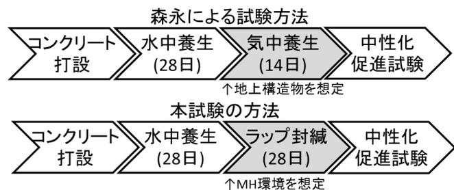
図 2. 森永の試験方法と本試験方法
