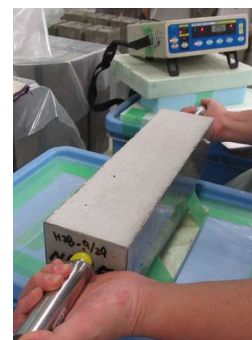
写真-3 超音波伝播速度の測定状況
