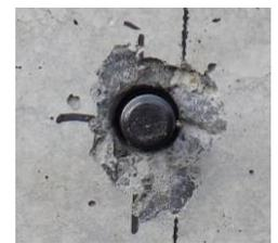
写真-3 新工法の接着剤無しの試験体施工後
